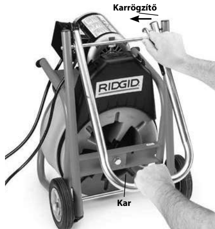
9. Ábra – A kar működtetése
