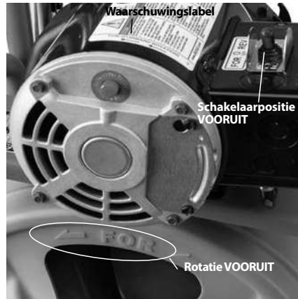
Figuur 8 – Correcte trommelrotatie (Schakelaarstand FOR (VOORUIT))
