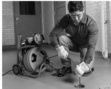
Figur 13 – I driftsposisjon, manuell mating av kabel
