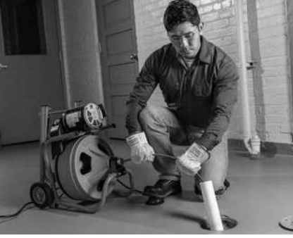
Şekil 10 – Makinenin Kablo Çıkışıdan 2' (0,6 m) Uzatılması Örneği
