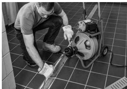
Figura 15 – Utilizar a K-400 com AUTOFEED (avanço automático)
