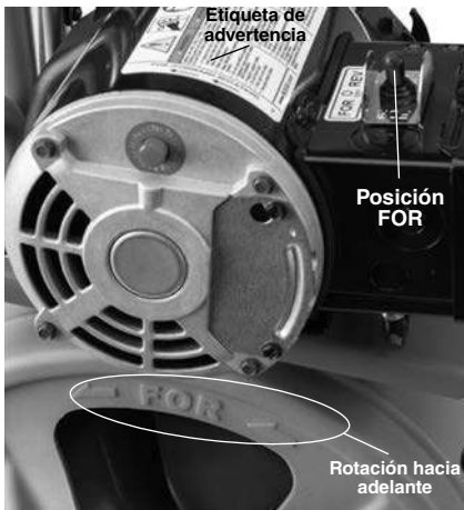
Figura 8 – Rotación correcta del tambor (el conmutador está en posición FOR)
