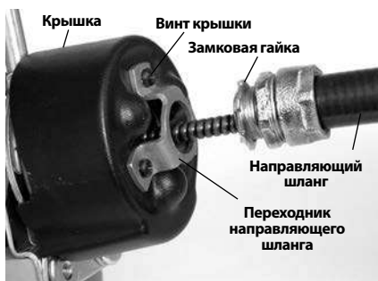
Рис. 6 – Крепление направляющего шланга к механизму подачи троса
