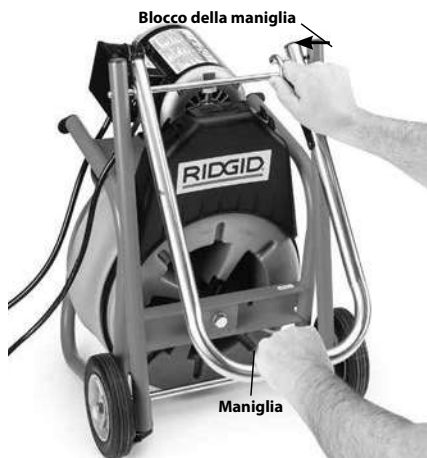
Figura 9 – Funzionamento della maniglia
