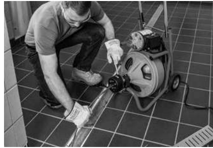
Figura 15 – Operarea K-400 cu dispozitivul AUTOFEED
