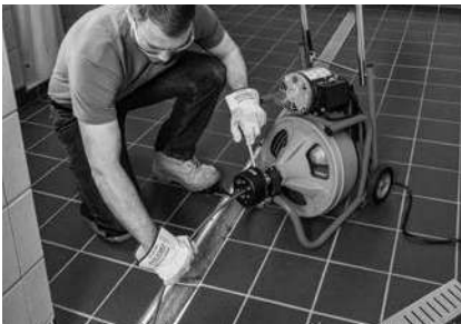
Figur 15 – Betjening af K-400 med AUTOFEED-enheden
