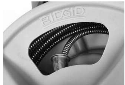
Şekil 18 – Spirali Makaraya Gösterildiği Gibi Sarın
