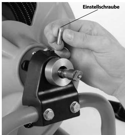
Abbildung 3 – Spiralsicherungsschraube entfernen und entsorgen
