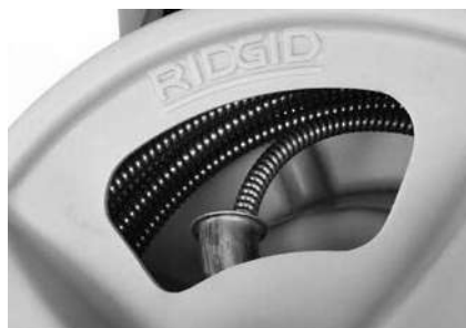
18-сурет – Кабельді барабанға суретте көрсетілгендей орап салыңыз
