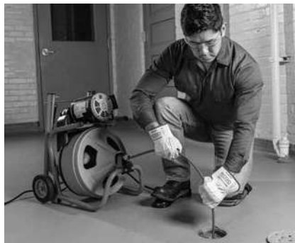
Figura 13 – În poziția de exploatare, cablu alimentat manual
