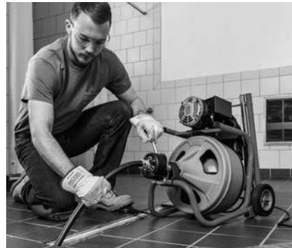
16. Ábra – A gép használata vezetőhüvellyel
