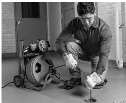
Figur 13 – Betjeningsposition, manuel indføring af spiralen
