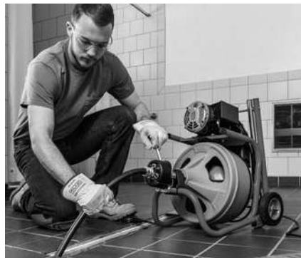
Abbildung 16 – Verwendung der Maschine mit Führungsschlauch
