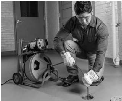
Abbildung 13 – In Betriebsposition, manueller Vorschub der Spirale
