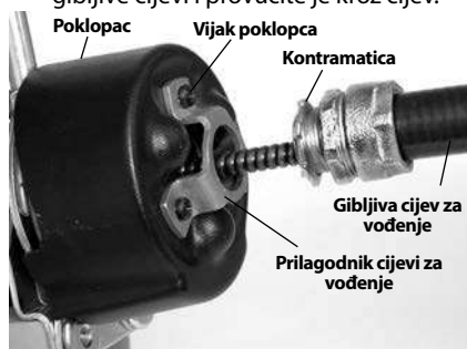
Slika 6 – Montiranje cijevi za vođenje na ulagač sajle
