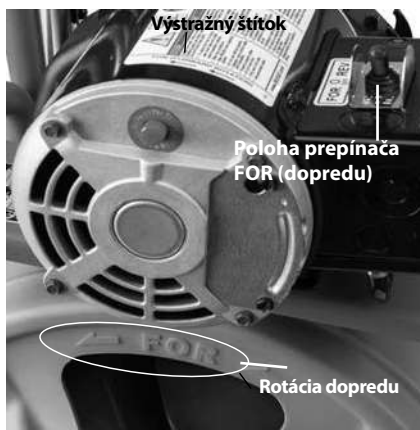
Obrázok 8 – Správna rotácia bubna (poloha prepínača FOR (DOPREDU))
