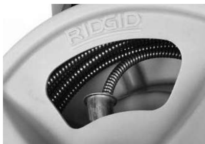
Rys. 18 – Układanie zwojów sprężyny w bębnie
