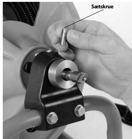
Figur 3 - Fjern og kassér sætskruen til spirallåsen
