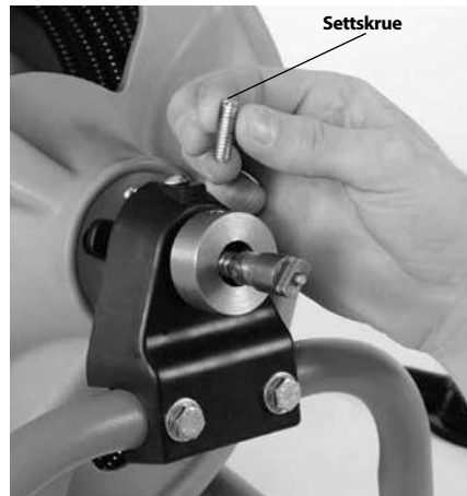
Figur 3 – Fjern og kasser kabellås-transportskruen
