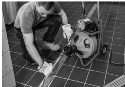
Kuva 15 – K-400-laitteen käyttö AUTOFEED-syötön kanssa.
