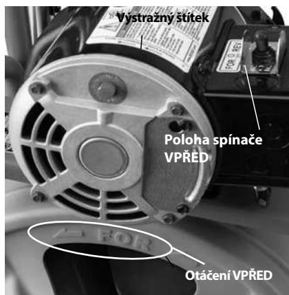
Obrázek 8 – Správné otáčení bubnu (Spínač v poloze FOR – vpřed)
