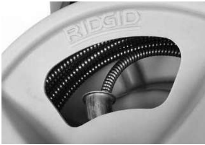
Slika 18 – Namotajte sajlu u bubanj kako je prikazano
