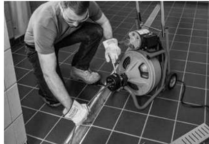
Obrázok 15 – Prevádzka stroja K-400 s mechanizmom AUTOFEED
