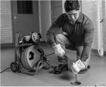
13-сурет – Жұмыс күйі, кабельді қолмен беру
