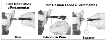
Figura 12 – Ligar/Desligar Ferramentas
