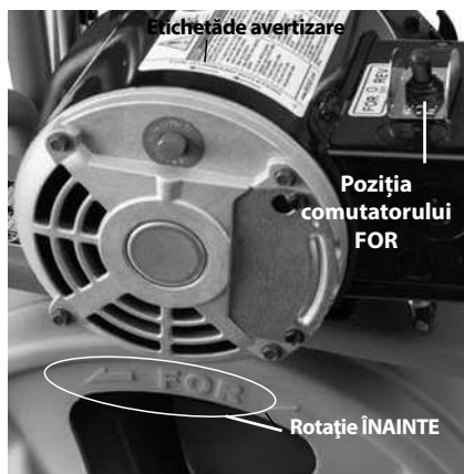
Figura 8 – Rotația corectă a tamburului (Poziția comutatorului FOR (ÎNAINTE))
