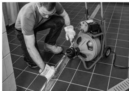
Figuur 15 – K-400 bedienen met de AUTOFEED
