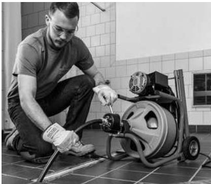
Obrazek 16 – Použití stroje s vodicí hadicí
