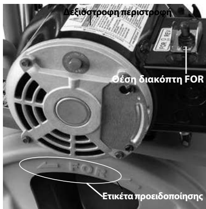
Εικόνα 8 – Ορθή περιστροφή τυμπάνου (Θέση διακόπτη FOR)
