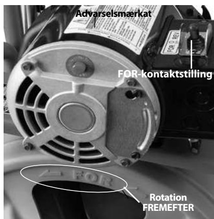
Figur 8 – Korrekt tromlerotation (kontakten er i positionen FOR)
