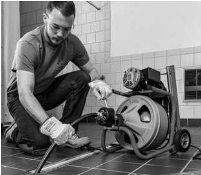
Figur 16 – Använda maskinen med styrslang
