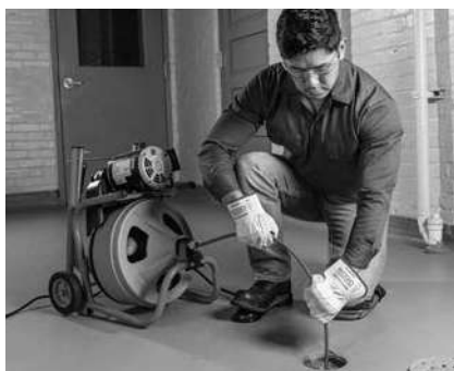
Slika 13 – U poziciji za rad, ručno uvlačenje sajle
