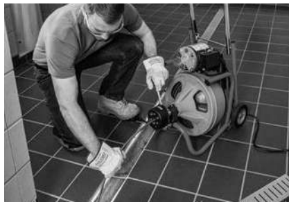
Slika 15 – Uporaba K-400 z AUTOFEED
