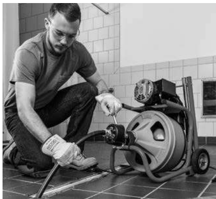
Figure 16 – Utilisation du guide-câble
