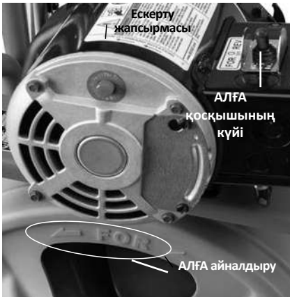
8-сурет – Барабанның дұрыс айналуы (АЛҒА қосқышының күйі)
