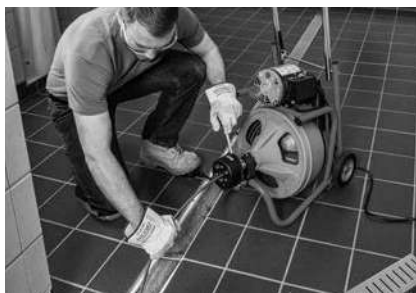
Figur 15 – Betjene K-400 med AUTOFEED (automating)
