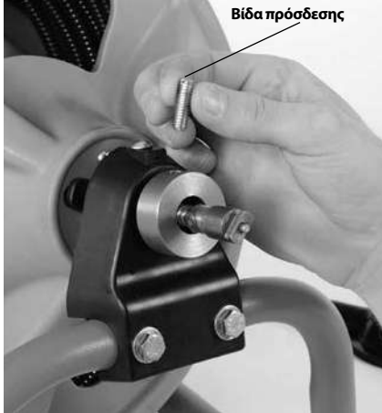
Εικόνα 3 – Αφαιρέστε και απορρίψτε τη βίδα πρόσδεσης σπирάλ
