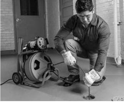
Şekil 13 – Çalıştırma Konumunda, Manüel Beslemeli Kablo
