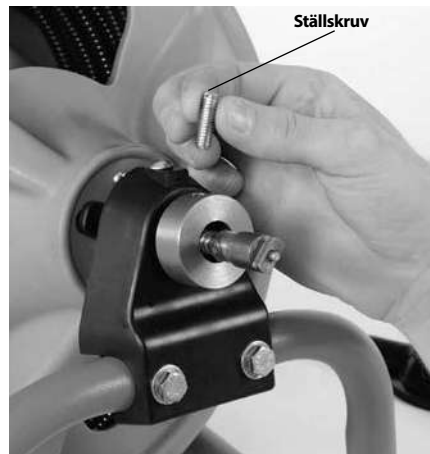
Figur 3 – Ta bort och kasta spirallåsskruven
