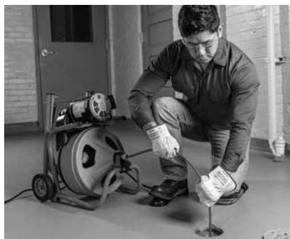
Obrázok 13 – V pracovnej polohe, manuálny posuv špirály
