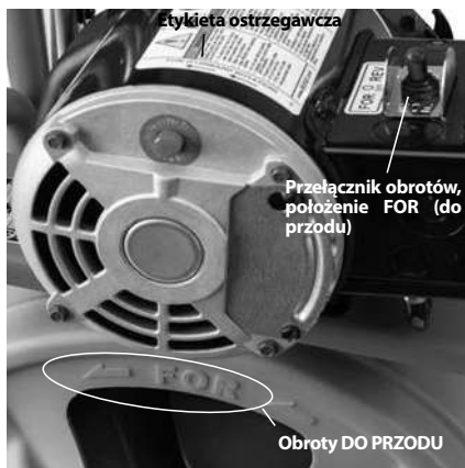
Rys. 8 – Właściwy kierunek obrotów bębna (przełącznik w położeniu FOR)
