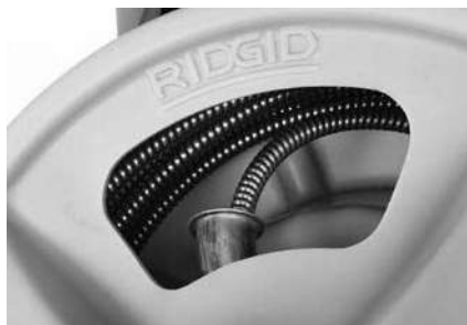
Figuur 18 – Wikkel de veer in de trommel op zoals afgebeeld
