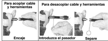
Figura 12 – Acoplamiento y desacoplamiento de herramientas al cable
