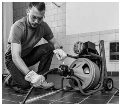
Kuva 16 – Laitteen käyttö suojaletkun kanssa
