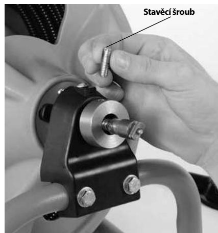
Obrázek 3 – Odstraňte a zlikvidujte stavěcí šroub uzávěru spirály
