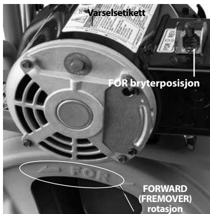
Figur 8 – Riktig trommelrotasjon (FOR-bryter posisjon)
