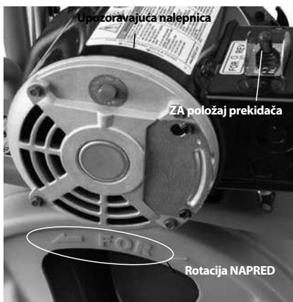
Slika 8 – Pravilno okretanje bubnja (pozicija prekidača FOR)
