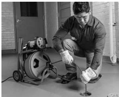
Рис. 13 – В рабочем положении, ручная подача троса
