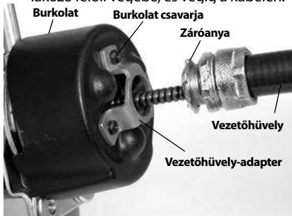
6. Ábra – A vezetőhüvely felszerelése a kábelelőtőlóra
