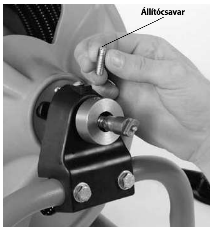
3. Ábra – A kábelzár csavar leszerelése és hulladékba helyezése
