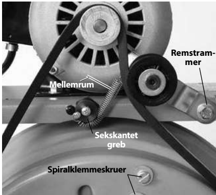
Figur 17 – Justering af torsionsbegrænser. (vist med remafskærmningen afmonteret)
