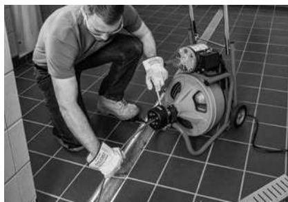
Slika 15 – Rad s K-400 s AUTOFEED
