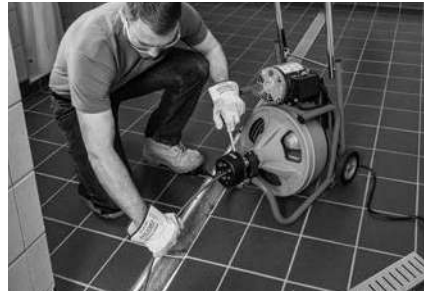
15. Ábra – A K-400 üzemeltetése – AUTOFEED
