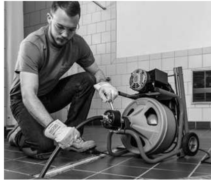
Figur 16 – Anvendelse af maskinen med føringslange
