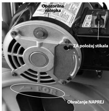
Slika 8 – Pravilno obračanje bobna (ZA položaj stikala)
