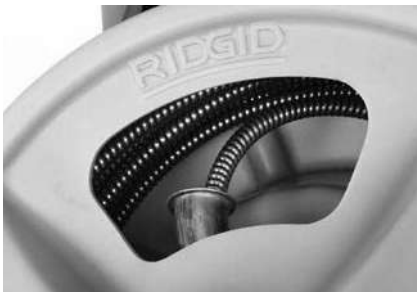
Figur 18 – Sno spiralen ind i tromlen som vist
