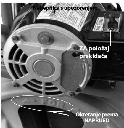
Slika 8 – Pravilno okretanje bubnja (ZA položaj prekidača)
