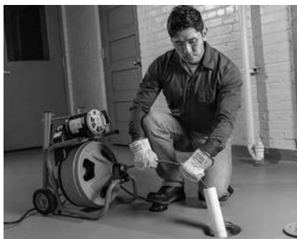
Figur 10 – Eksempel på forlængelse af afløbet, så det er inden for 2' (0,6 m) af spiraludgangen
