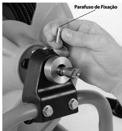
Figura 3 – Retire e elimine o Parafuso de Fixação de Bloqueio de Cabo
