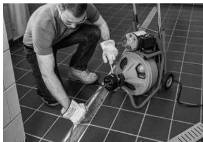
Рис. 15 – Эксплуатация модели K-400 с механизмом автоподачи AUTOFEED
