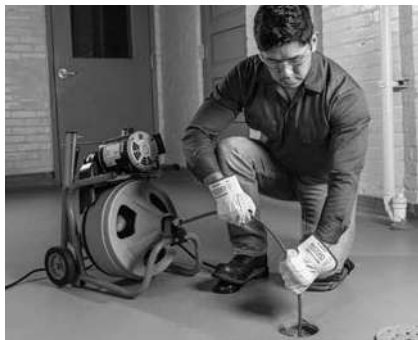
Obrázek 13 – V pracovní poloze, ruční posouvání spirály
