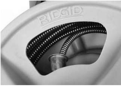
Abbildung 18 – Spirale in die Trommel wickeln, wie gezeigt
