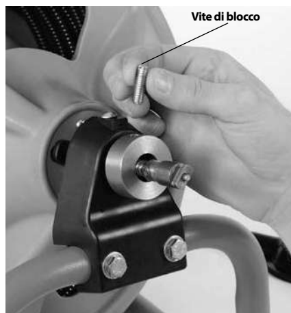
Figura 3 – Rimuovere e smaltire la Vite di blocco del cavo
