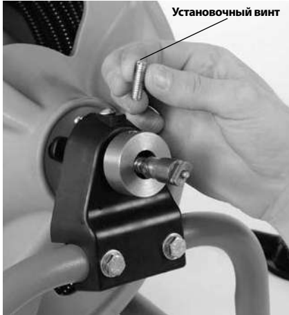
Рис. 3 – Выкрутите и утилизируйте установочный винт фиксации троса
