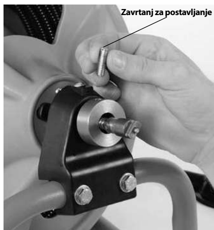
Slika 3 – Skinite i odbacite sigurnosni utični zavrtnj sajle
