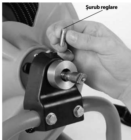
Figura 3 – Îndepărtați și aruncați șurubul de blocare a cablului
