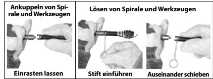
Abbildung 12 – Anschließen/Abnehmen von Werkzeugen
