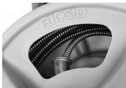
Figur 18 – Kveil kabelen i trommelen som vist
