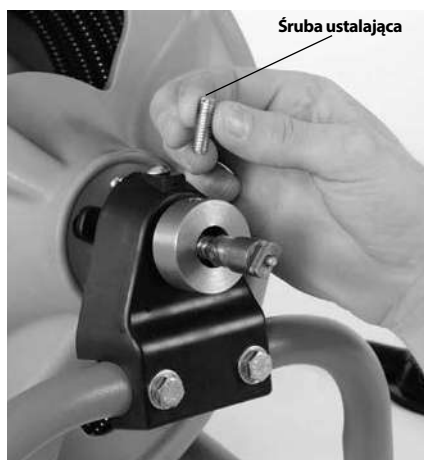
Rys. 3 – Wykręcić i zutilizować śrubę blokującą sprężynę
