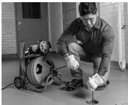
Rys. 13 – Ręczne wprowadzanie sprężyny w położeniu obsługi
