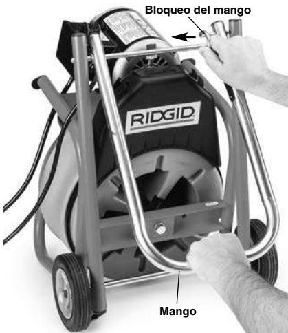
Figura 9 – Operación del mango
