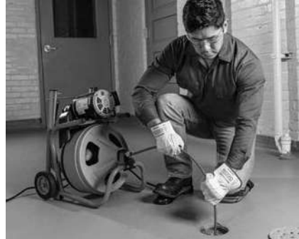
Kuva 13 – Käyttöasennossa, käsin syötettävä jousi
