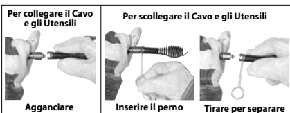
Figura 12 – Connessione/disconnessione degli utensili
