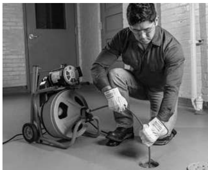
Εικόνα 13 – Σε θέση λειτουργίας, χειροκίνητη προώθηση του σπιράλ
