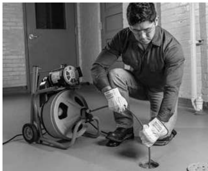
Figur 13 – Manuell spiralframmatning i arbetsläget
