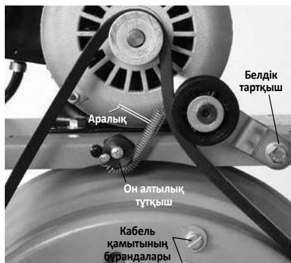
17-сурет – Айналдыру моментін шектегішті реттеу. (Белдік қорғанышы алынып тасталғандағы көрінісі)
