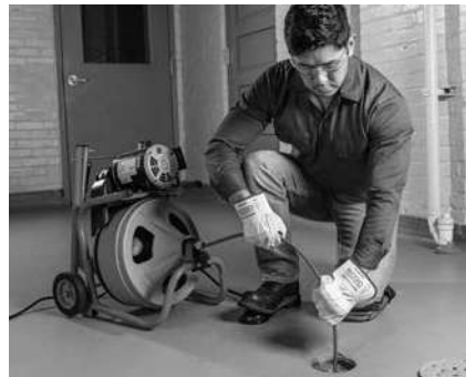
Slika 13 – U položaju rada, ručno uvlačenje sajle
