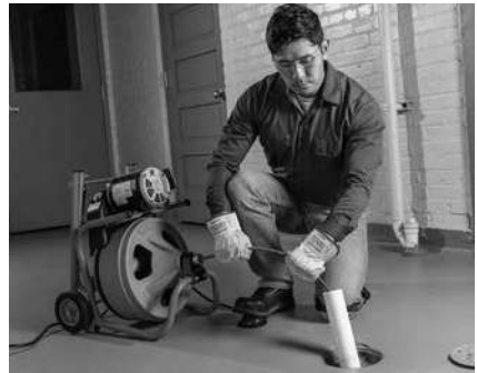
Kuva 10 – Esimerkki viemärin jatkamisesta 2' (0,6 m) päähän jousen ulostulosta.
