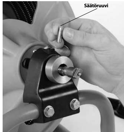
Kuva 3 – Irrota ja hävitä jousen lukitussäätöruuvi
