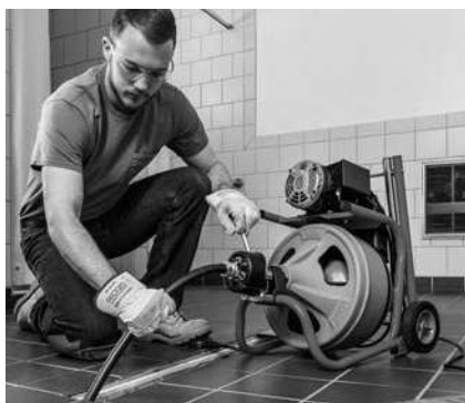
16-сурет – Құрылғыны бағыттауыш құбыршекпен пайдалану
