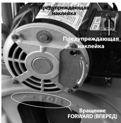
Рис. 8 – Надлежащее вращение барабана (Положение переключателя ВПЕРЕД)
