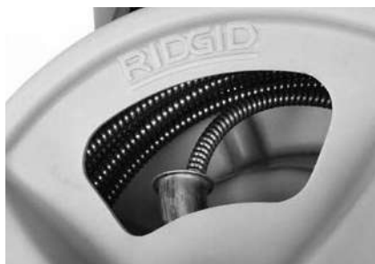
Slika 18 – Kabel tuljave v boben, kot je prikazano
