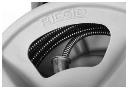
Εικόνα 18 – Περιέλιξη του σπιράλ στο τύμπανο όπως εικονίζεται
