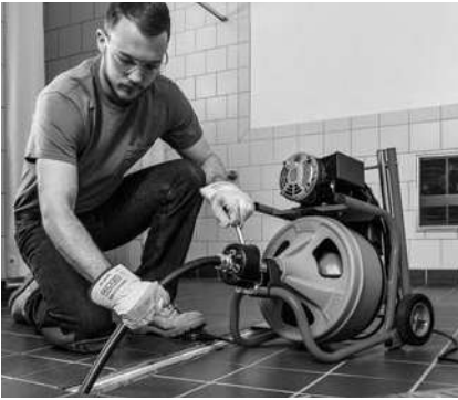
Figuur 16 – Machine gebruiken met geleidingslang
